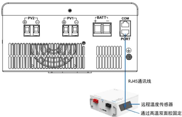
注：控制器在未连接远程温度传感器的情况下，默认25°C对电池充电，无温度补偿。
