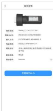
**步骤3:** 进入“网关详情”界面，显示网关相关信息。WiFi模块配网完成后，展示路由器的WiFi名称以及密码。点击
