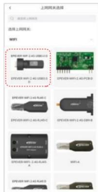
**步骤6:** 选择 EPEVER WiFi 2.4G USB3.0 D，自动返回到步骤5的“网关和设备添加”界面。扫描网关标签上的二维码<sup>(1)</sup>或者手动输入22位网关SN；选择地理位置（非必填项）；勾选信息提示。
