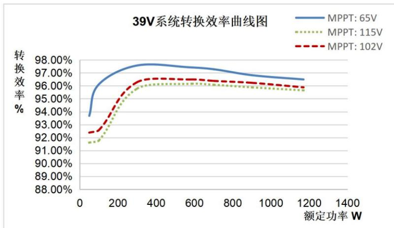
4. 光伏阵列最大功率点电压 (68V, 102V,119V) /系统电压 (52V)
