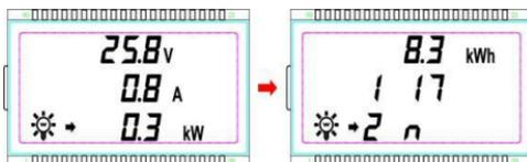
负载显示：电压/电流/功率/累计电量/负载工作模式时段一/负载工作模式时段二
