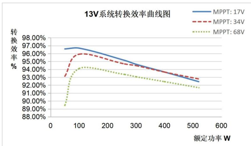
2. 光伏阵列最大功率点电压 (34V, 68V, 102V) /系统电压 (26V)
