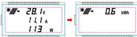
光伏阵列显示：电压/电流/功率/发电量
