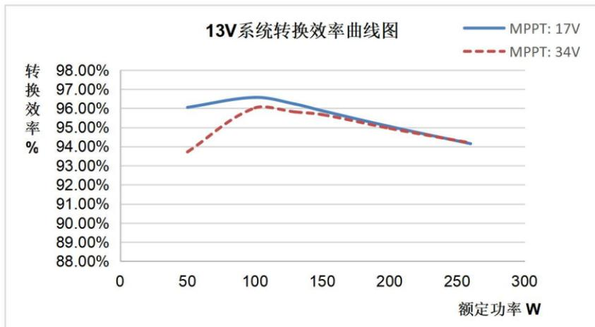
2. 光伏阵列最大功率点电压 (34V, 42V) /系统电压 (26V)
