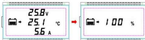
蓄电池显示：电压/电流/温度/容量
