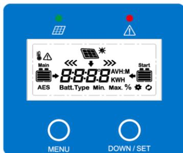
备注：水平视线和液晶屏的角度在 90° 范围内才可以清晰的看到液晶屏的显示内容。如果角度超过 90°，液晶屏的显示内容无法看清。
