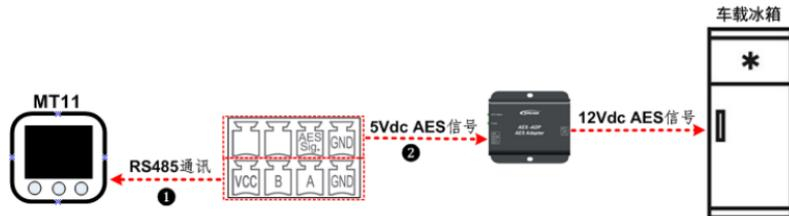
① 通讯线名称：直通RS485通讯线（以下3个型号根据长度不同可选）
