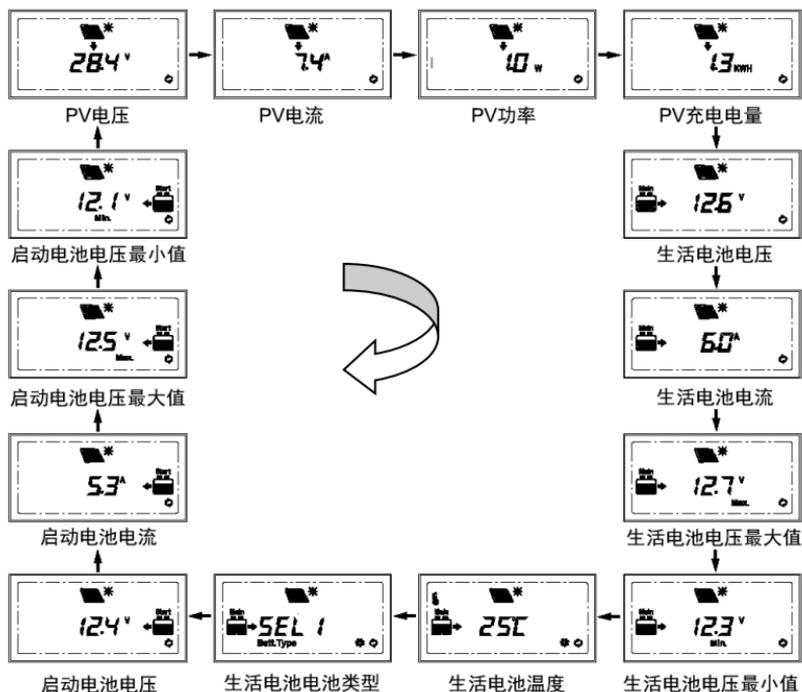
循环显示：PV 电压 → PV 电流 → PV 功率 → PV 充电电量 → 生活电池电压 → 生活电池电流 → 生活电池电压最大值 → 生活电池电压最小值 → 生活电池温度 →
