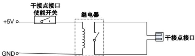
**继电器的参数：** 额定值 5A/30VDC； 最大值 0.5A/60VDC
