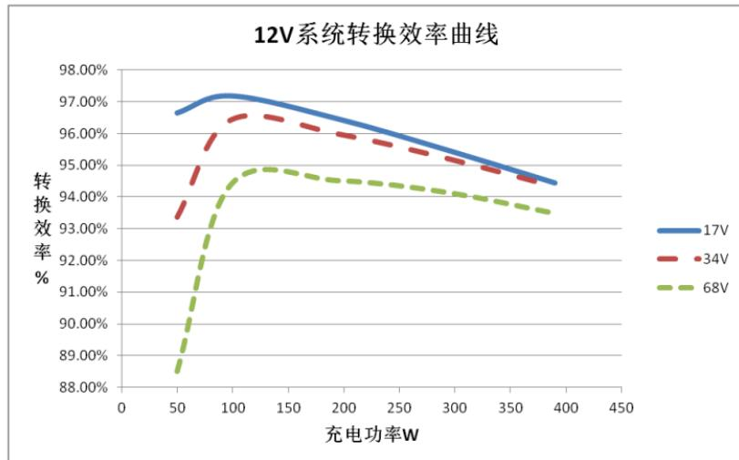
2.光伏阵列最大功率点电压(34V, 68V,102V)/系统电压(24V)
