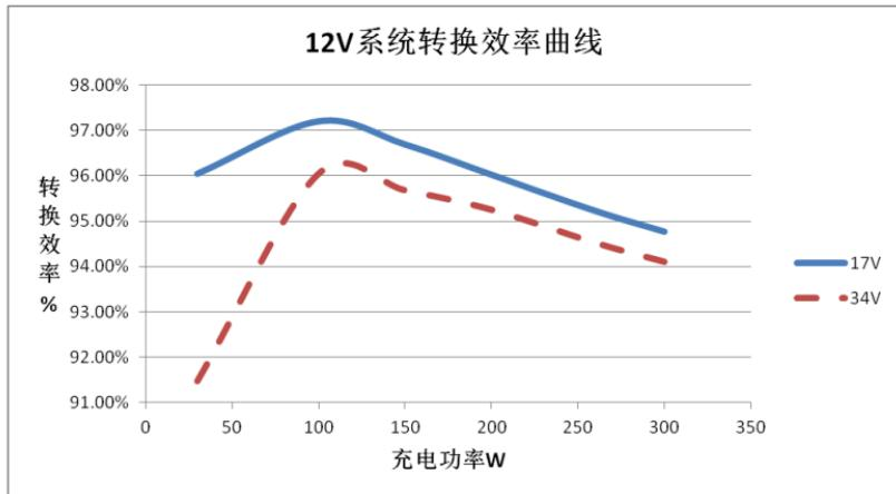
2. 光伏阵列最大功率点电压(34V)/系统电压(24V)
