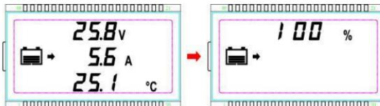
蓄电池显示：电压/电流/温度/容量
