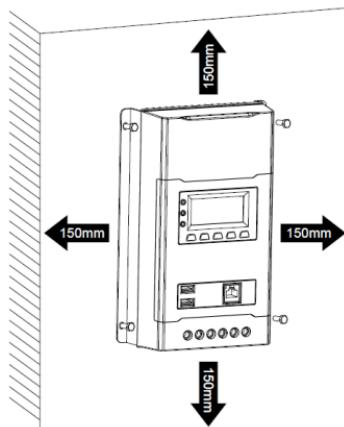
图 2-1 安装示意图
