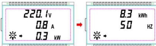
负载显示：电压/电流/功率/累计电量/频率
